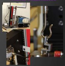
Static testing machine Zwick/Roell BT1-FR2.5TS.D14 (n° serie 179392)
